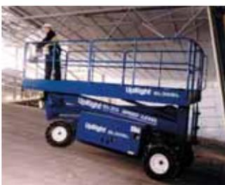
Alle Modelle sind mit Pendelachse ausgerüstet, damit die Antriebsräder bei Unebenheiten Bodenkontakt halten. Und sie bieten eine hohe Steigfähigkeit an steilen Hängen und auf Verlade-Rampen.
