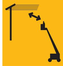
**Achtung:** Durch Windeinwirkung können die Freileitungen stark schwingen. Dadurch kann der notwendige Abstand unterschritten werden. Die in der Betriebsanleitung angegebenen Abstände können größer sein und sind einzuhalten. Durch die elektromagnetischen Felder kann es zu Funktionsstörungen der FHAB kommen.
