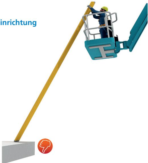
Genau so ist es verboten, den Ausleger bzw. die Arbeitsbühne (Korb) zwecks Stabilisierung an Bauteilen oder Gebäuden abzustützen oder anzulehnen.
